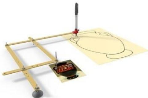
Obrázek 3: Mechanismus pantografu<sup>5</sup>
