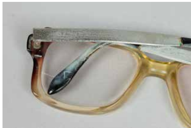
Obr. 10. Brýle z CA a CAP a koroze kovu způsobená dlouhodobým kontaktem s těmito materiály
