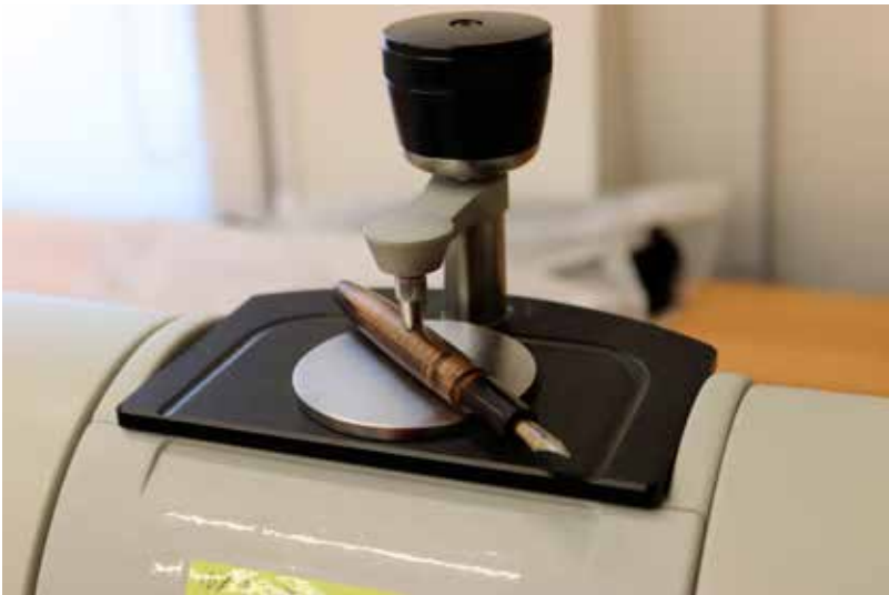
Obr. 2. Přenosný FTIR spektrometr při získávání spektra plnicího pera (CN)
