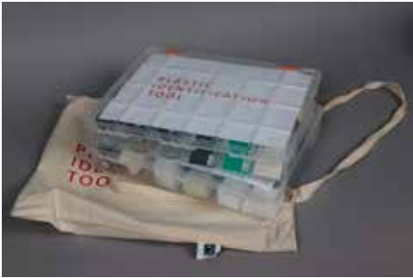
Obr. 3. PIT-kit s referenčními vzorky a dalšími pomůckami sloužící k orientační identifikaci pomocí nástroje Plastic Identification Tool
